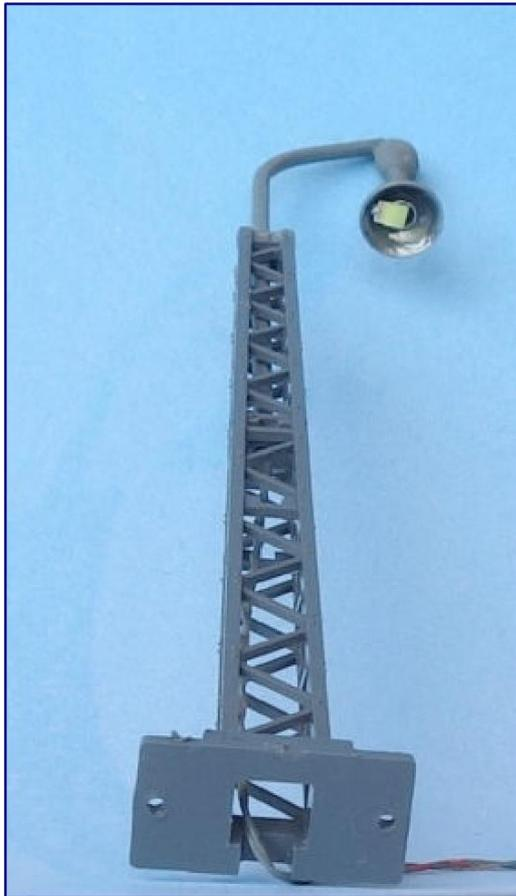
Das im Gittermast sichtbare Kabel zur LED sollte, wie auch der Leuchtenaufsatz, grau lackiert werden (Bild oben links), nur der Reflektor im Schirm bleibt blank. Haben wir alle wichtigen Bauschritte abgeschlossen, erfolgt ein erster Funktionstest, bevor es an (optionale) Feinarbeiten geht (Bild oben rechts).
